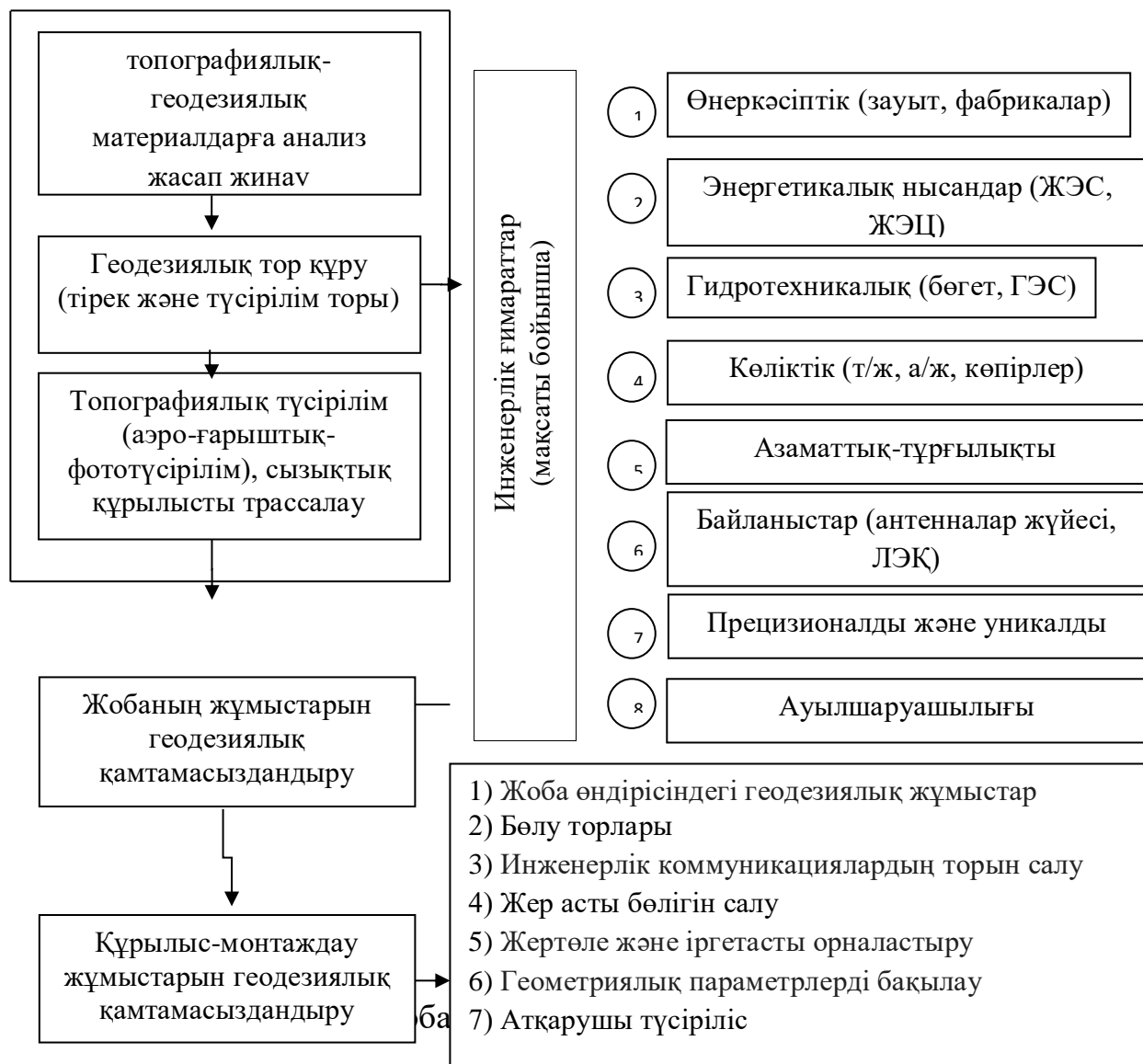
Кесте 2.1 – Құрылысты геодезиялық қамтамасыздандыру технологиясының схемасы
