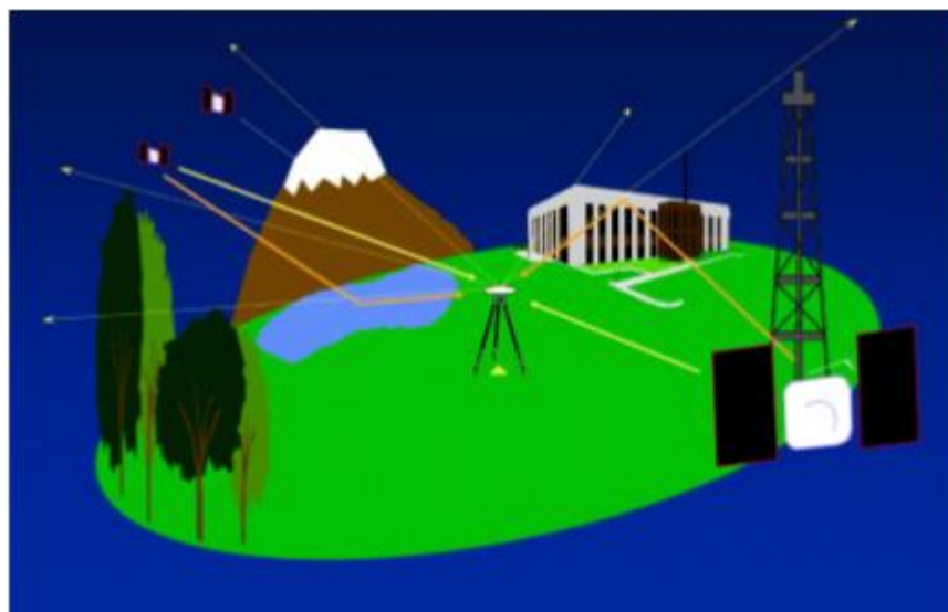
2.9 – сурет– ГНСС өлшеу кезінде өлшеу процесін қиындататын кедергілер мен бірнеше сигналдар пайда болуы .
