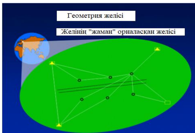
2.5 – сурет– Үлгі желісін түсіру желісі "жаман" геометриясын орналасқан үлгідегі
